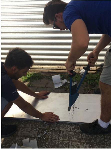
Abbildung 2: Die Bordwände werden vernietet. Die Kombination Bizeps und Nietzange erwies sich als zuverlässiger als die vorhandene hydraulische Nietpistole.
