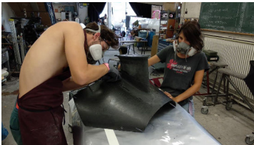
Abbildung 34: Fertigstellung der Messcowling
