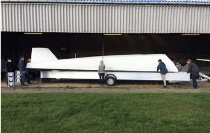
Abbildung 4: Beim Zusammenbau gab es geringfügige Differenzen zwischen den Deckel- und Unterbaumaßen. Traue keinem CAD-Modell, was du nicht selbst erstellt hast.
