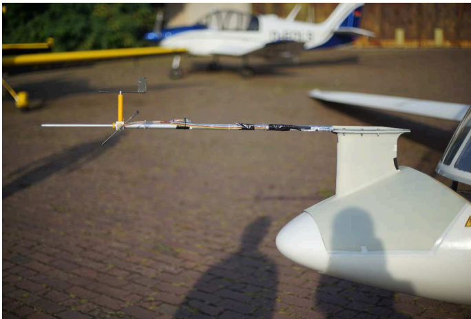
Abbildung 14: Messcowling der B13 auf dem Sommertreffen 2019
