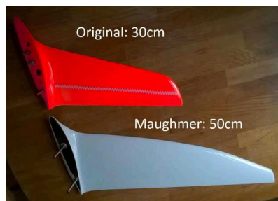
Abbildung 38: Die beiden Winglets im Vergleich
