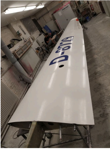
Abbildung 26: Der fertig lackierte Flügel und nebenbei fleißiges Arbeiten an der Elektronik
