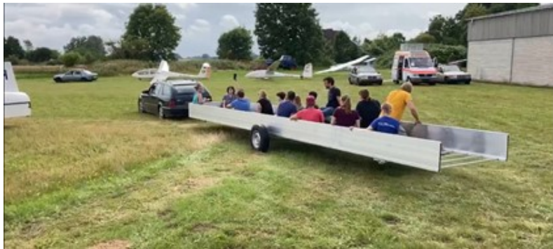
Abbildung 3: Der Unterbau mit gut einer Tonne Fleischgewicht auf Jungfernfahrt. Die hintere Bodenplatte fehlt hier noch, weswegen die hinteren Querstreben freiliegen.
